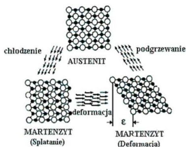
Rys. 4. Przemiany struktury krystalicznej – nitinol (Ćwikła 2008).
