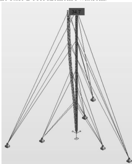
Rys. 7. Maksymalne przemieszczenia wierzchołka masztu.
