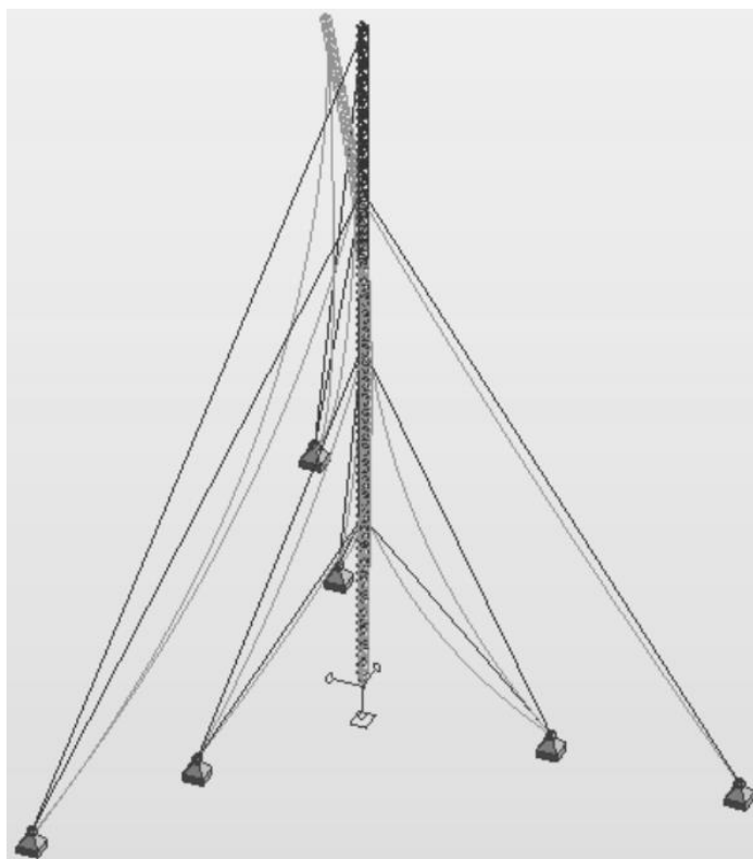
Rys. 3. Deformacja masztu po zerwaniu odciagu.
