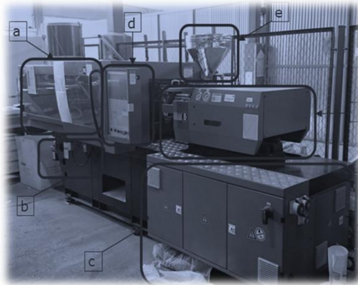
Rys. 3. Wtryskarka Borsche BS60 z wyróżnionymi elementami składowymi: a - przestrzeń robocza formy z układem zamykania, b - układ smarowania, c - układ zasilania, d - układ sterowania (panel sterowania), e - lej zasypowy, f - agregat wtryskowy.
