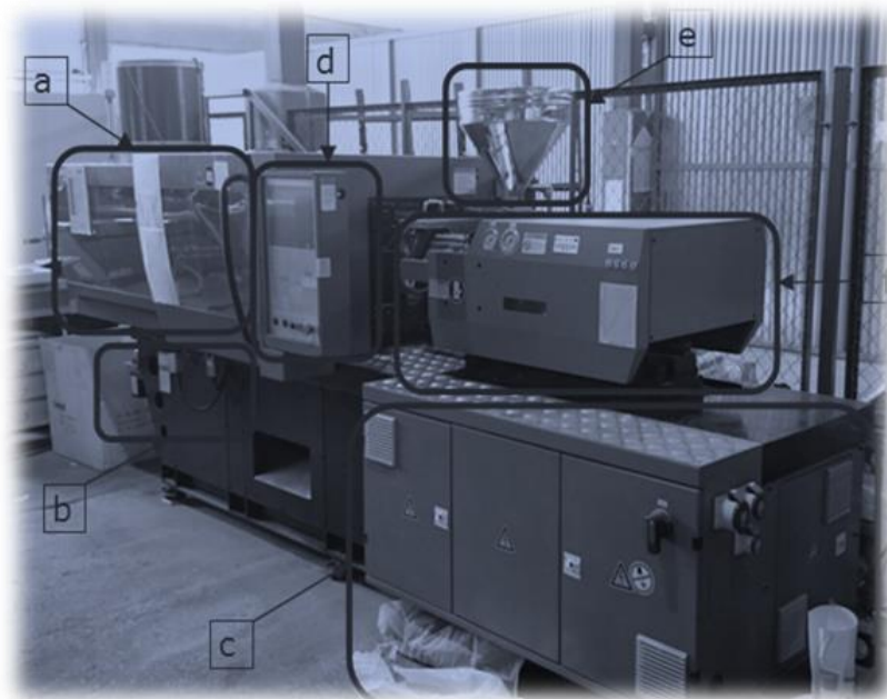
Rys. 3. Wtryskarka Borsche BS60 z wyróżnionymi elementami składowymi: a - przestrzeń robocza formy z układem zamykania, b - układ smarowania, c - układ zasilania, d - układ sterowania (panel sterowania), e - lej zasypowy, f - agregat wtryskowy.
