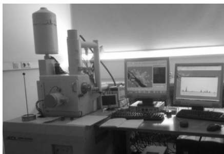
Rys. 3. Widok skaningowego mikroskopu elektronowego firmy JOEL typ JSM 6480 wraz z oprogramowaniem EDS 2006.
