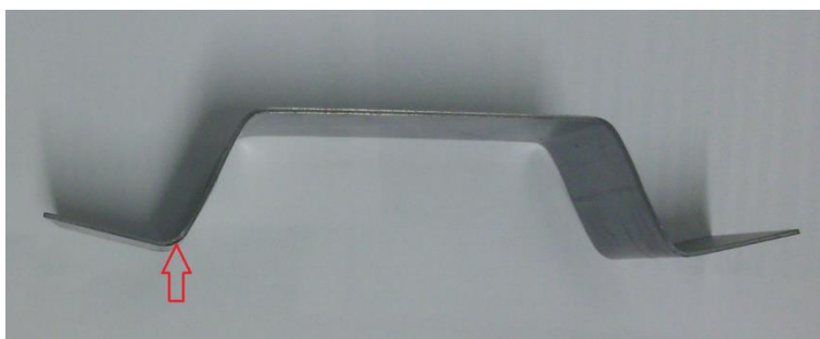
Rys. 1. Kształt badanej wytłoczki oraz miejsce pobrania materiału do badań. Stal TRIP690.
