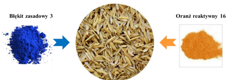
Rys. 4. Łuski ryżowe jako adsorbent zastosowany do usuwania barwników zasadowych i reaktywnych.
