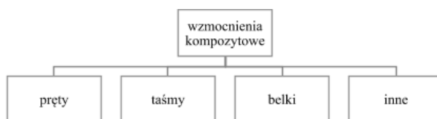
Rys. 2. Wybrane wzmocnienia kompozytowe stosowane w budownictwie.
