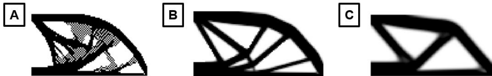
Rys. 19. Wpływ parametru r_{min} na wyniki otrzymane metodą SIMP.
