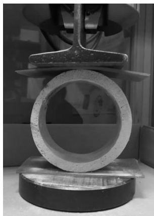
Rys. 26. Próbkę podczas badania wytrzymałości na ściskanie promieniowe.
