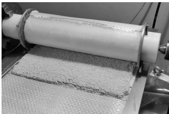
Rys. 25. Tkanina z ułożoną mieszanką żywiczną i granulatem podczas nawijania środkowej części rury na rdzeń.
