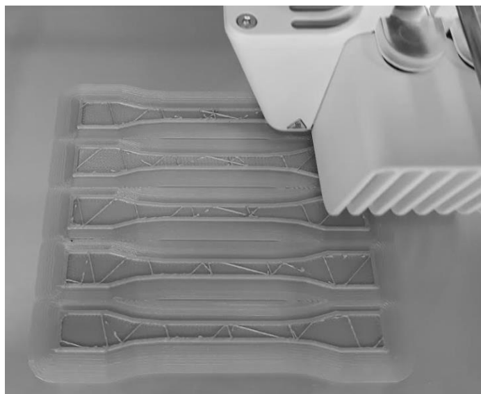
Rys. 2. Drukarka Ultimaker 3 podczas druku serii próbek o wypełnieniu 10%.
