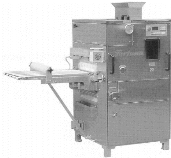
Rys. 5 Widok ogólny dzielarki włączonej w linie automatyczną.
