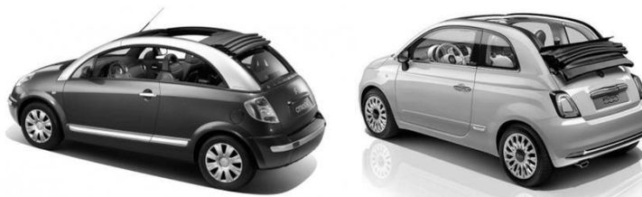
Rys. 5. Nadwozie cabrio jako rozwinięcie faltdachu, od lewej – Citroen C3 Pluriel oraz Fiat 500 Cabrio (materiały firmy Citroen i Fiat).
