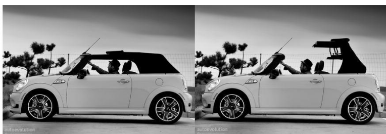
Rys. 7. Dach przesuwno-składany w BMW Mini cabrio , po lewej faza przesuwania poszycia dachu, po prawej faza rozkładania ( www.autoevolution.com ).
