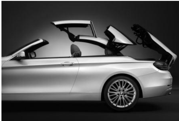
Rys. 8. Składany dach hardtop o konstrukcji typu „sandwich” w BMW serii 4 (materiały firmy BMW).
