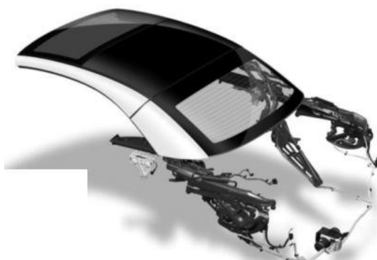
Rys. 11. Dach składany z oknem dachowym stosowany w Volkswagenie Eos (materiały firmy Volkswagen).
