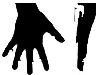
Rys. 2. Zdjęcie po procesie binaryzacji z progiem 0,26, po operacjach morfologicznych i po usunięciu krawędzi statywu.
