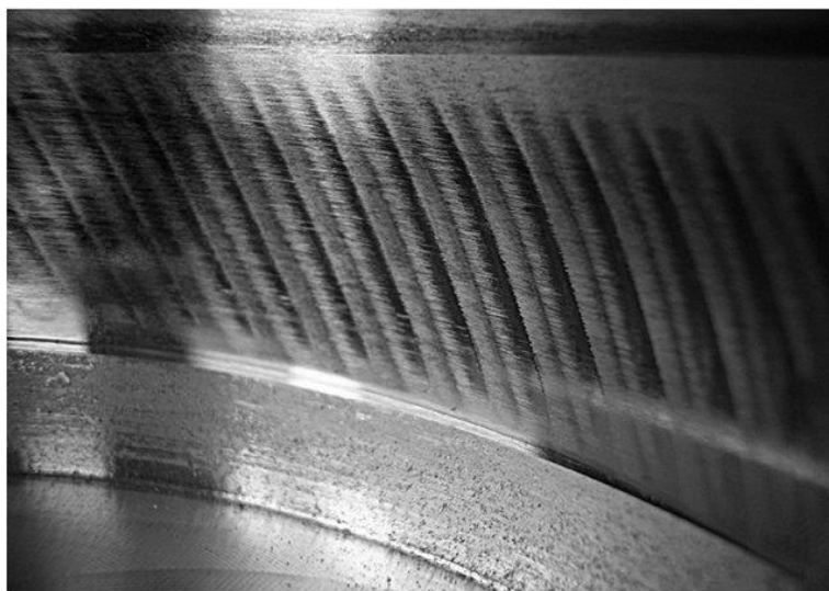
Rys. 2. Obraz powierzchni przedmiotu obrabianego po wystąpieniu zjawiska drgań chatter (Parsian 2013).
