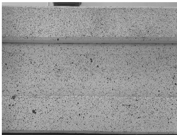
Rys. 2. Przykładowy deseń naniesiony na dwuteową belkę drewnianą.
