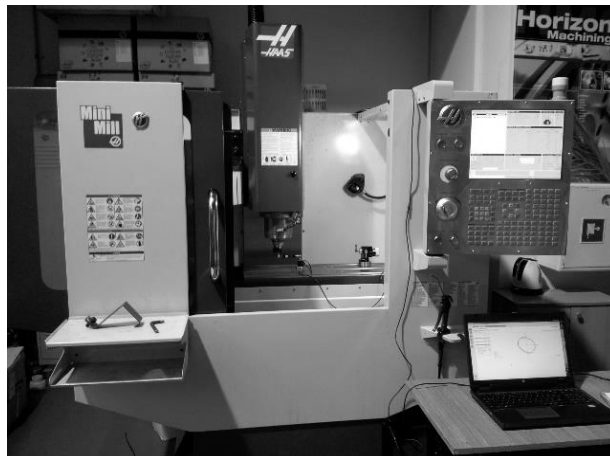
Rys. 3. Stanowisko badawcze do pomiaru błędów obrabiarki przy użyciu systemu QC10 Ballbar.
