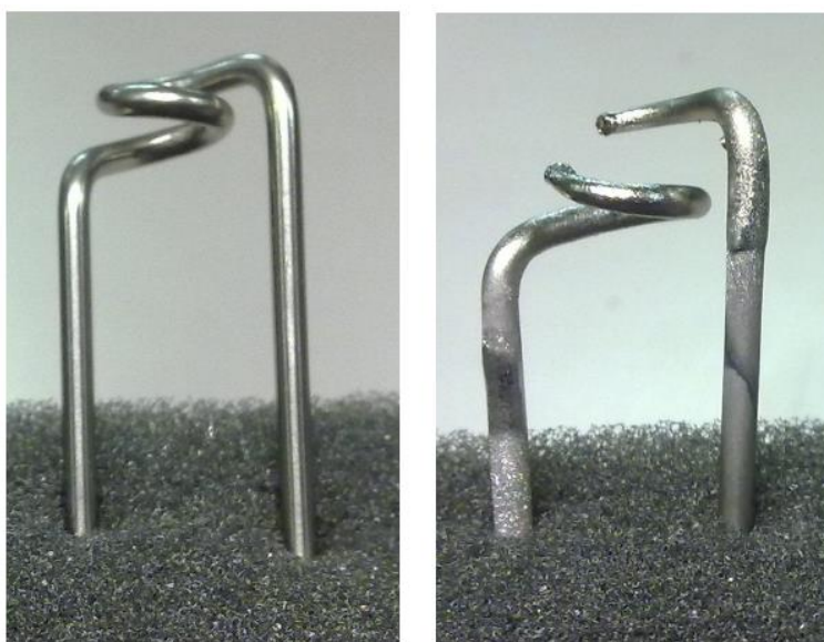
Rys. 6. Głowica (żarnik) maszyny implementującej jony (z lewej – nowy, z prawej – uszkodzony), (Susto GA i in. 2013).
