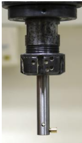
Rys.4. Wprowadzone niewyważenie – widoczny odważnik wkręcony w wałek zamocowany w wrzecionie.
