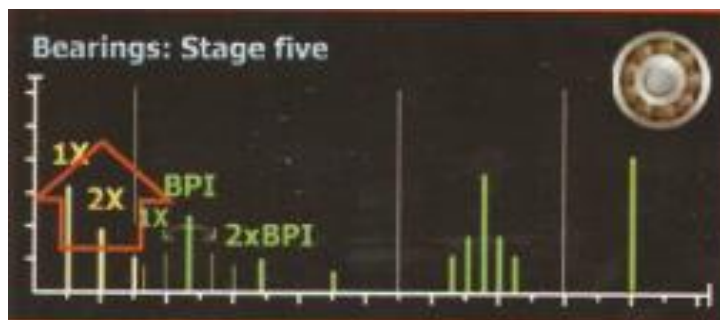
Rys. 5. Widmo FFT dla piątego etapu uszkodzenia łożyska (Mobius Institute 2005).
