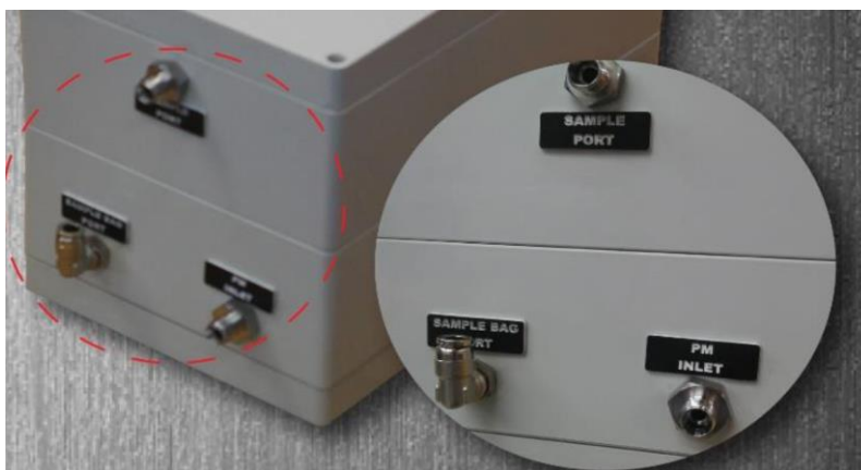
Rys. 6. Wloty powietrza systemu pomiarowego (Scentroid 2017).
