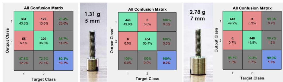
Rys. 6. Wynikowe macierze rozbieżności przedstawiające wyniki klasyfikacji dwuklasowy problemu rozróżnienia wrzeciona uszkodzonego od sprawnego, od lewej: wałek bez odważnika, wałek z odważnikiem nr 1, wałek z odważnikiem nr 2.
